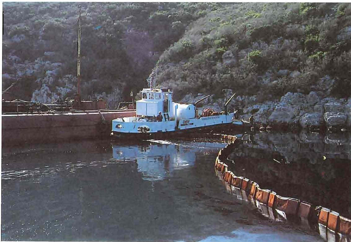
ILIAD - Récupération des hydrocarbures en mer
