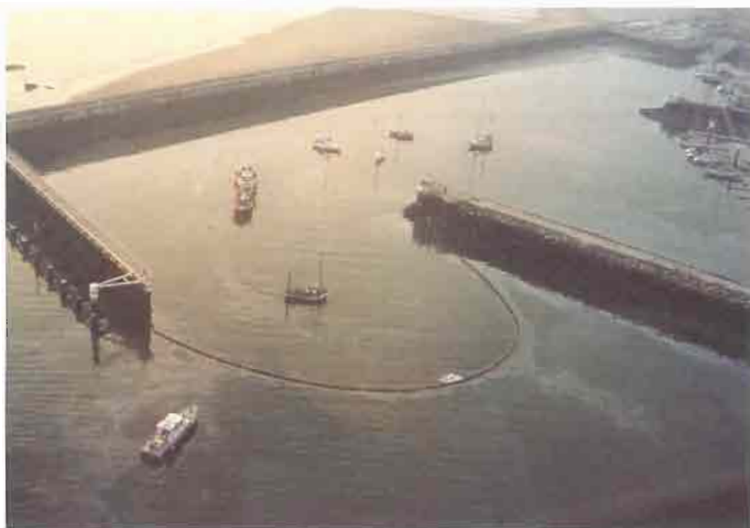
Sinistre du Katja - barrage condamnant l'entrée d'un port de plaisance (source: ITOPF)
