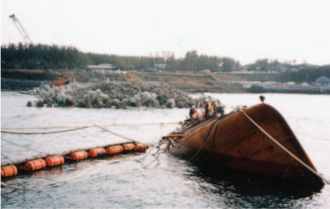
*Opération visant à enlever les hydrocarbures de la partie avant échouée du Nakhodka*
