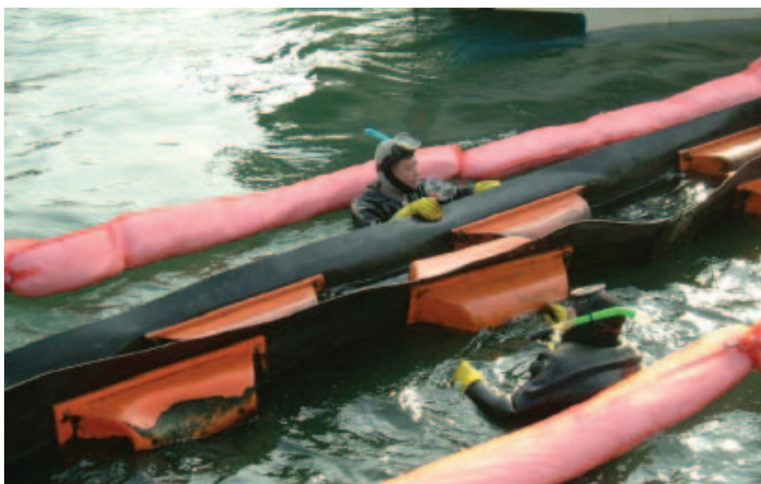
Plongeurs réparant les barrages utilisés pour lutter contre le sinistre du Jeong Yang
