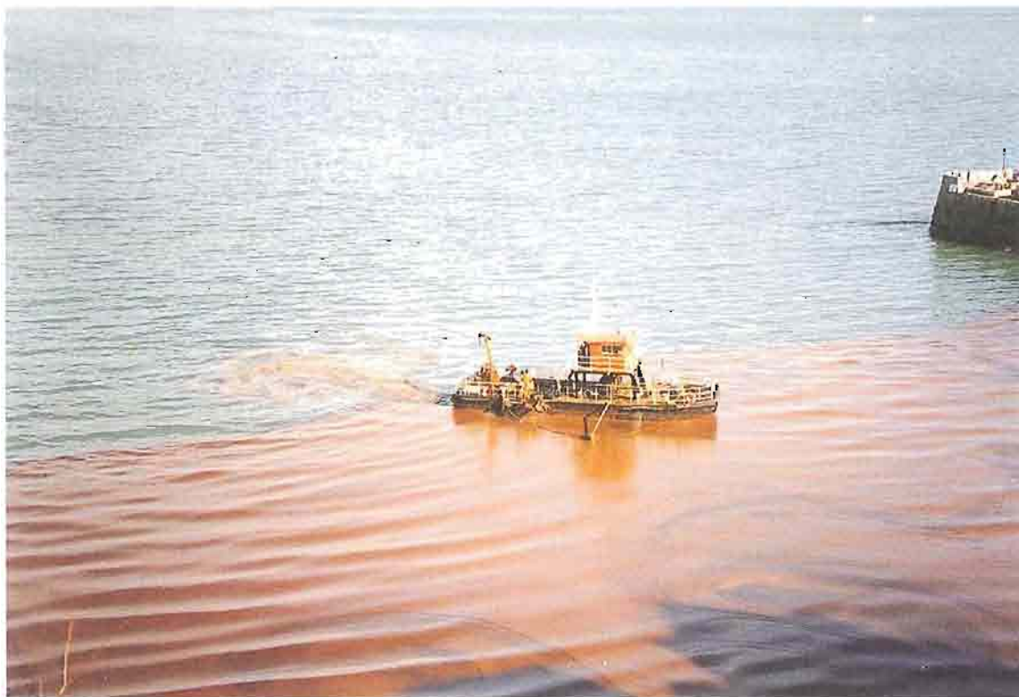
Sea Empress – un écremeur à l'œuvre (photographie: FIPOL)
