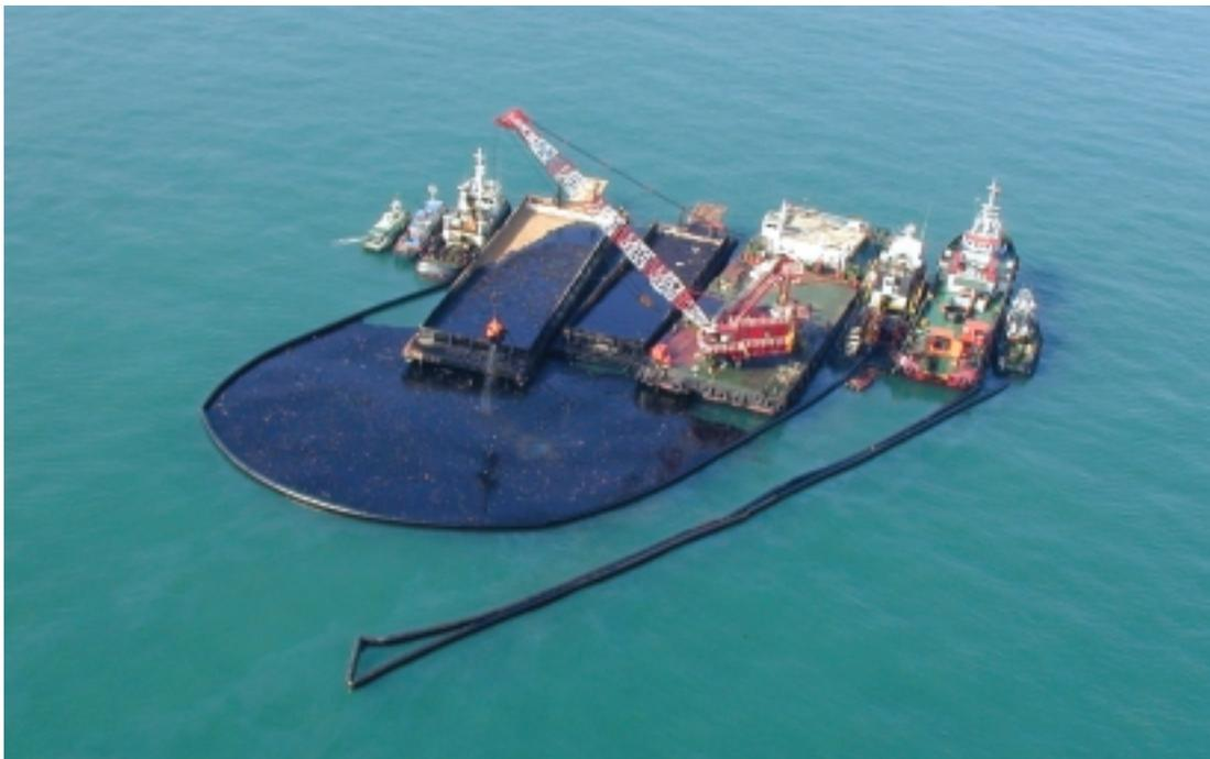
*Natuna Sea: confinement et récupération en mer d'hydrocarbures altérés par l'exposition aux intempéries*
