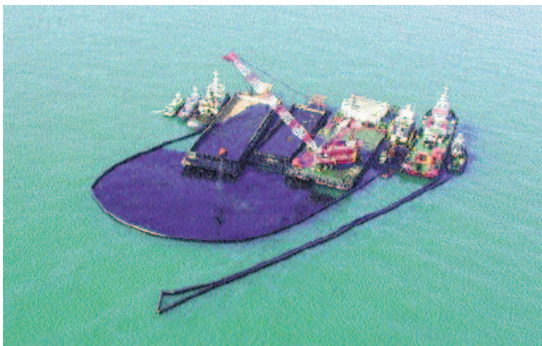
Natuna Sea: contención y recuperación en el mar de hidrocarburos alterados por la intemperie
