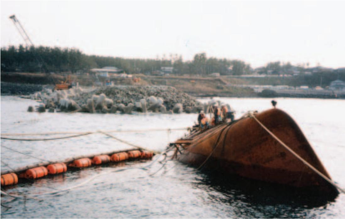
*Operación para extraer hidrocarburos de la sección de proa varada del Nakhodka*
