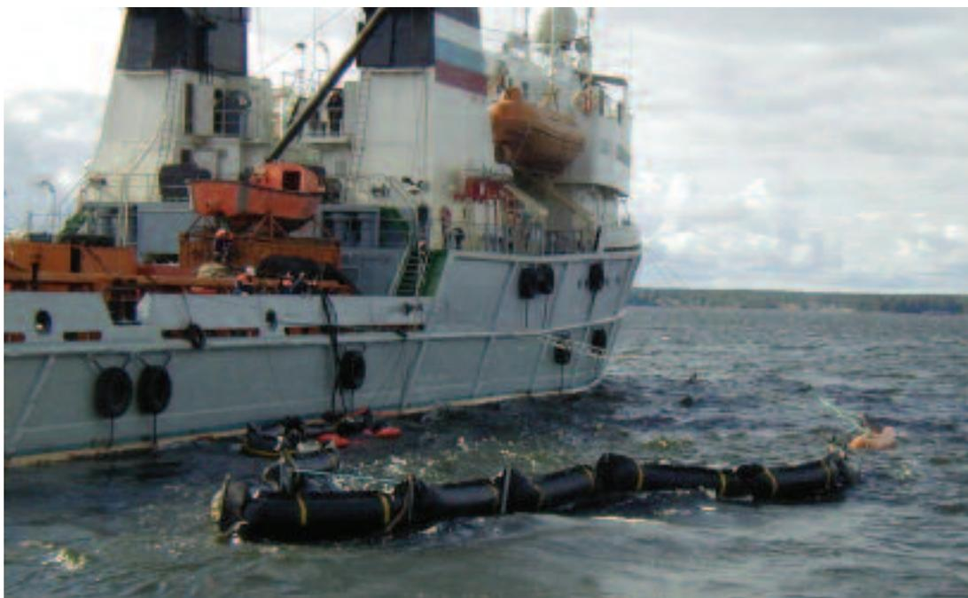
*Volgoneft 139: Recuperación de hidrocarburos con un sistema de barreras flotantes remolcadas en el mar*
