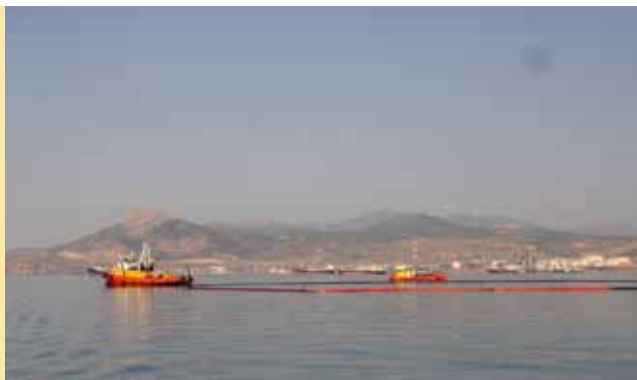
Barreras desplegadas alrededor del Alfa I hundido.
